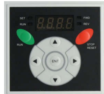
Hình 3.1: Màn hình biến tần
